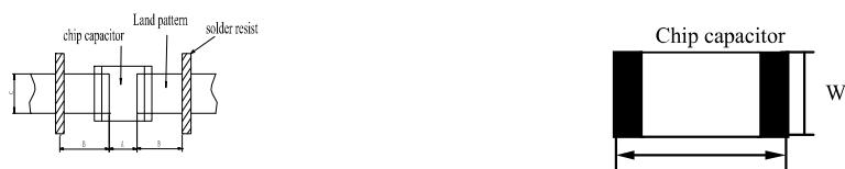
再流焊接时推荐设计的尺寸 (单位: mm)
